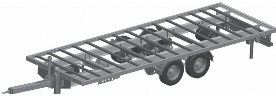
Modell des LKW-Leichtbauanhängers. Die Masse kann durch den Einsatz von Leichtbaumaterialien aus Faserkunststoff-Verbunden deutlich reduziert werden. Derzeit befinden sich die ersten Prototypen in der Fertigung.
